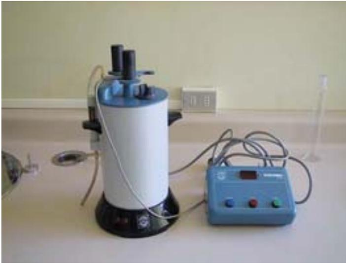
Foto 2. "Falling number", instrumento para determinar el grado de brotación de un trigo.
